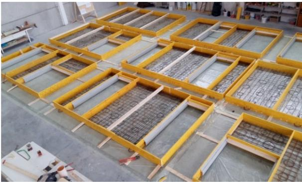
Centro di produzione delle pareti con assemblaggio, a misura delle tavole di contorno e irrigidimento, posa armatura setto di anima
