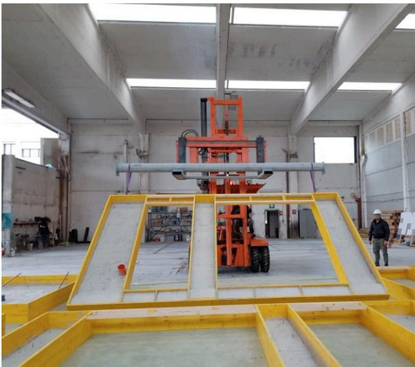
Movimentazione, con muletto, in stabilimento e in piazzale per il carico su autocarro
